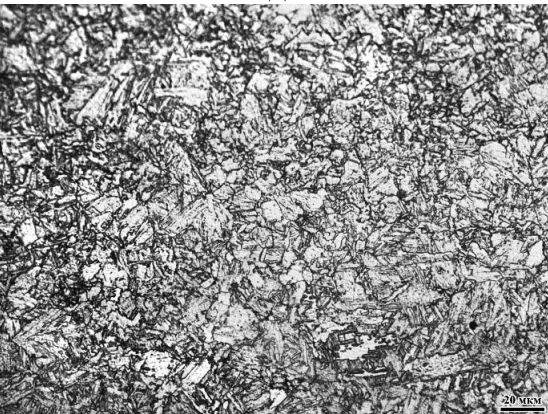
Рисунок 5.12 - Микроструктура листового проката толщиной 16 мм (а, б), 20 мм (в, г), 25 мм (д, е) и 30 мм (ж, з) на поверхности (а, в, д, ж) и в середине по толщине (б, г, е, з)
