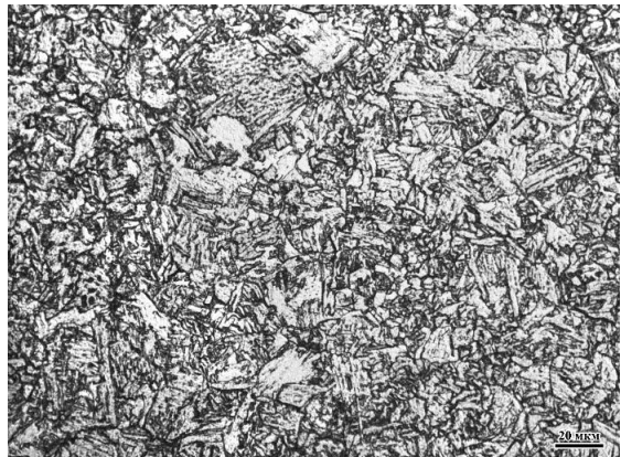
Рисунок 5.12 - Микроструктура листового проката толщиной 16 мм (а, б), 20 мм (в, г), 25 мм (д, е) и 30 мм (ж, з) на поверхности (а, в, д, ж) и в середине по толщине (б, г, е, з)
